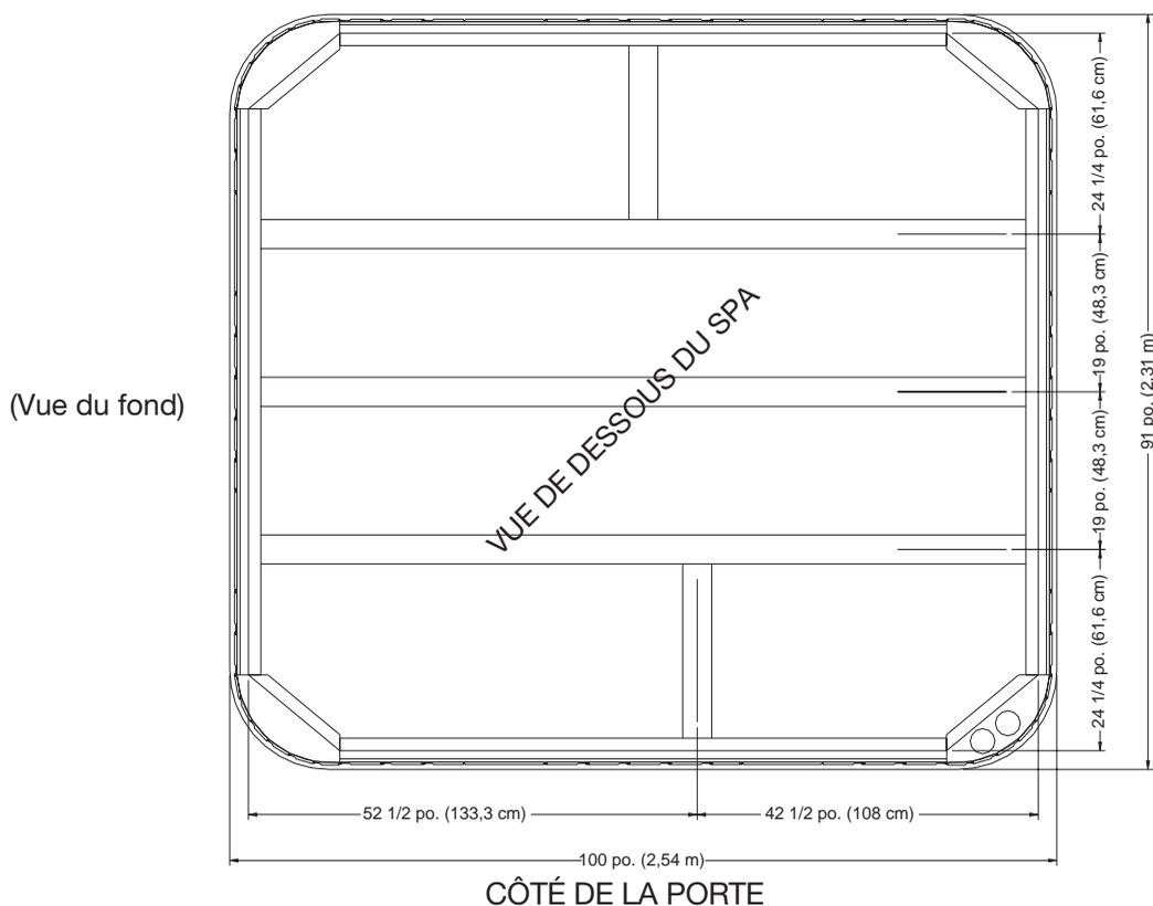
**REMARQUE :** Watkins Manufacturing Corporation exige que le spa *Grande*e soit installé sur une dalle en béton armé d'une épaisseur minimum de 10 cm ou sur une terrasse pouvant soutenir plus de 555 kg/m<sup>2</sup>.
