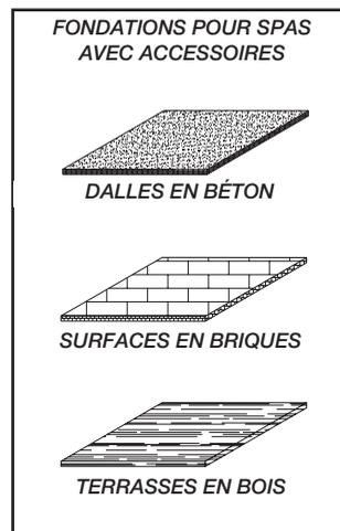
Si vous achetez une terrasse ou un belvédère avec votre spa, l'utilisation de solides fondations est requise. L'installation de l'ensemble sur toute autre surface qu'une seule dalle nivelée risque de créer des problèmes d'installation. Quelques exemples de surfaces recommandées sont illustrés à la page précédente.
