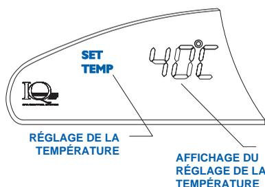
Pour afficher la température sélectionnée, appuyez sur la touche TEMP Plus (+). La température s'affiche à moins que le verrouillage du spa ne soit activé, auquel cas le mot SPA et le cadenas s'afficheront. L'affichage de la température disparaîtra automatiquement après 30 secondes.
