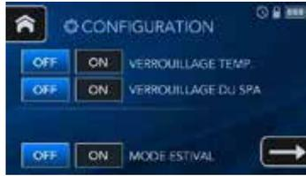
La fonction verrouillage de la température empêche tout changement du réglage de la température souhaitée de l'eau. Toutes les autres fonctions du panneau de commandes
