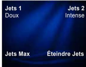
la ou les pompes à jet. Lorsque la touche de fonction **JETS** est enfoncée, est enfoncée, le menu jets s'affiche sur le panneau de commandes alors que le Jet 2 est en régime Faible (modèles **VANGUARD** et **ARIA**), l'icône de Pompe à jets s'affiche aussi sur l'écran d'accueil. Appuyez sur n'importe quelle touche de
