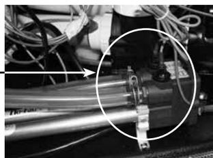
le plus rapide pour réactiver le spa consiste à d'abord mettre celui-ci totalement hors tension, puis à réchauffer les deux capteurs situés sur la partie supérieure du réchauffeur et le tuyau en vinyle (se trouvant dans le bloc technique) à l'aide d'un sèche-cheveux pendant environ dix minutes. Lorsque vous estimez que les capteurs et le réchauffeur ont été suffisamment réchauffés, mettez à nouveau le spa sous tension.
