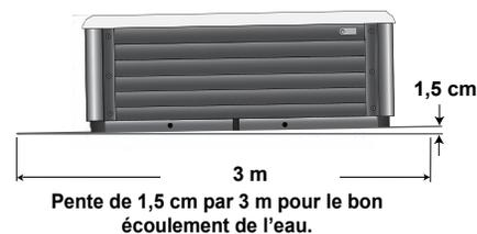
Il est important de noter que les surfaces meubles ont tendance à s'affaisser et que le spa ne sera donc plus à niveau, même lorsque des dalles de béton sont utilisées pour répartir le poids de manière homogène.
