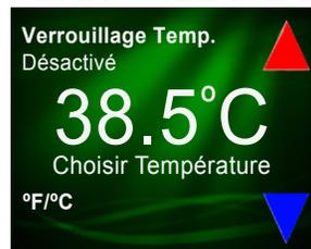
Lorsqu'elle est activée, la fonction Verrouillage de la température empêche tout changement du réglage de la température souhaitée de l'eau. Toutes les autres fonctions du panneau de commandes fonctionnent normalement tandis que le verrouillage de la température
