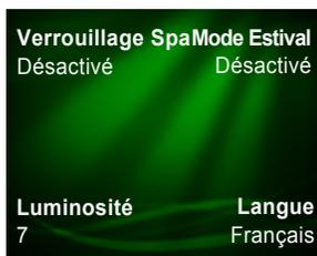
Lorsqu'elle est activée, la fonction de verrouillage du spa désactive toutes les fonctions du panneau de commandes. Cela évite que d'autres personnes non autorisées puissent modifier les réglages des jets, des éclairages et de la température de votre spa. Le panneau de commandes ne réagit à
