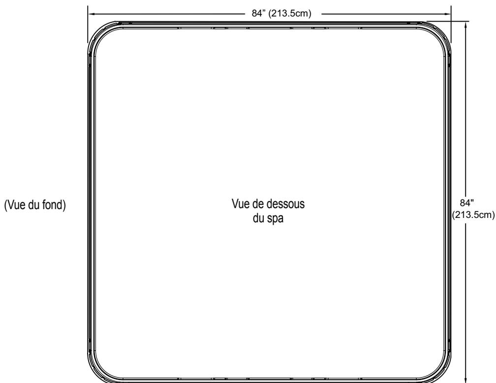
**REMARQUE :** Watkins Manufacturing Corporation exige que le spa **FLAIR** soit installé sur une dalle en béton armé d'une épaisseur minimum de 10 cm ou sur une terrasse dotée d'une structure solide capable de supporter le „poids mort“ indiqué dans le tableau des spécifications du spa.
