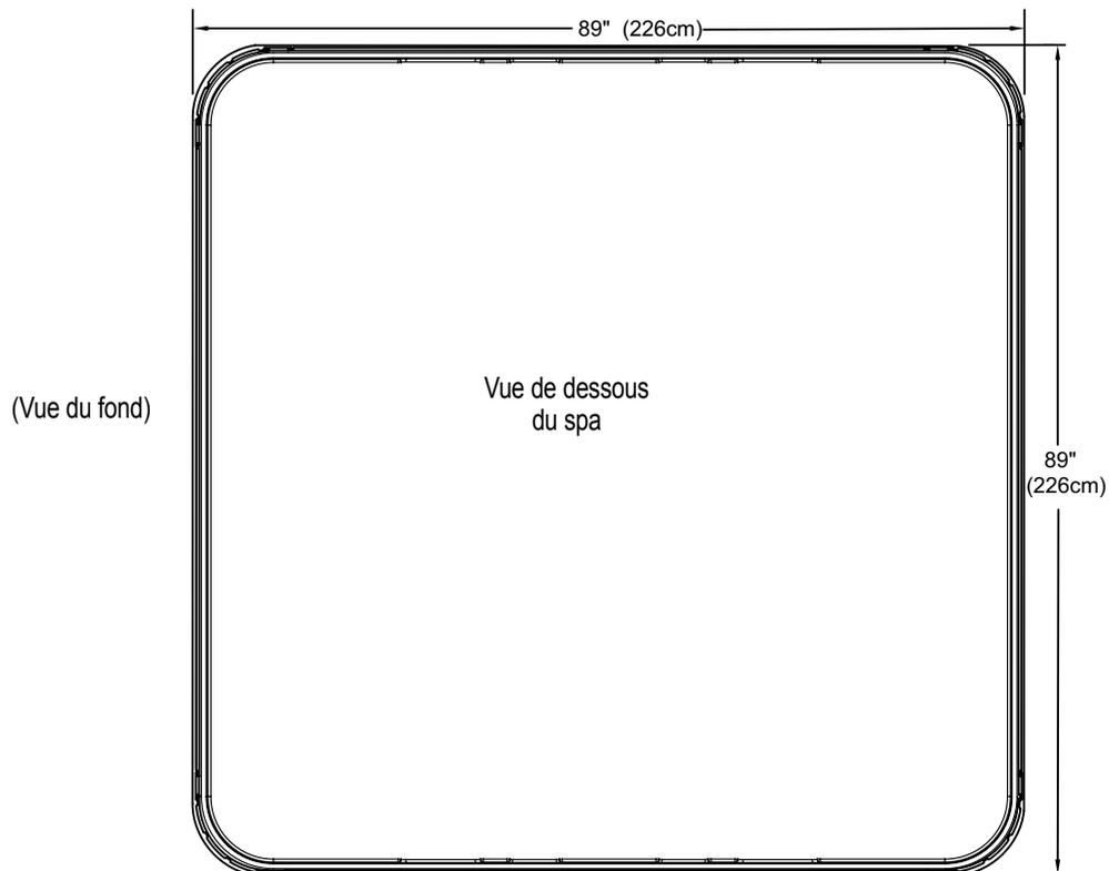
**REMARQUE :** Watkins Manufacturing Corporation recommande que le spa **PULSE/DL** soit installé sur une dalle en béton armé d'une épaisseur minimum de 10 cm ou sur une terrasse dotée d'une structure solide capable de supporter le « poids mort » indiqué dans le tableau des spécifications du spa.
