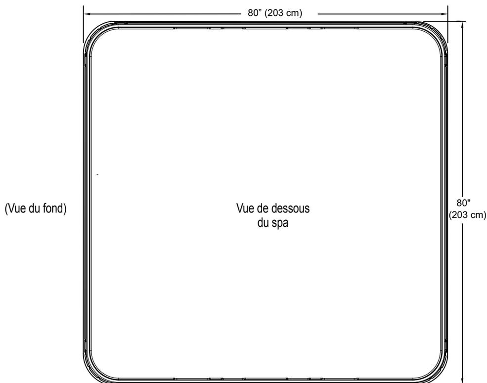
**REMARQUE :** Watkins Manufacturing Corporation exige que le spa **BOLT** soit installé sur une dalle en béton armé d'une épaisseur minimum de 10 cm ou sur une terrasse dotée d'une structure solide capable de supporter le „poids mort“ indiqué dans le tableau des spécifications du spa.
