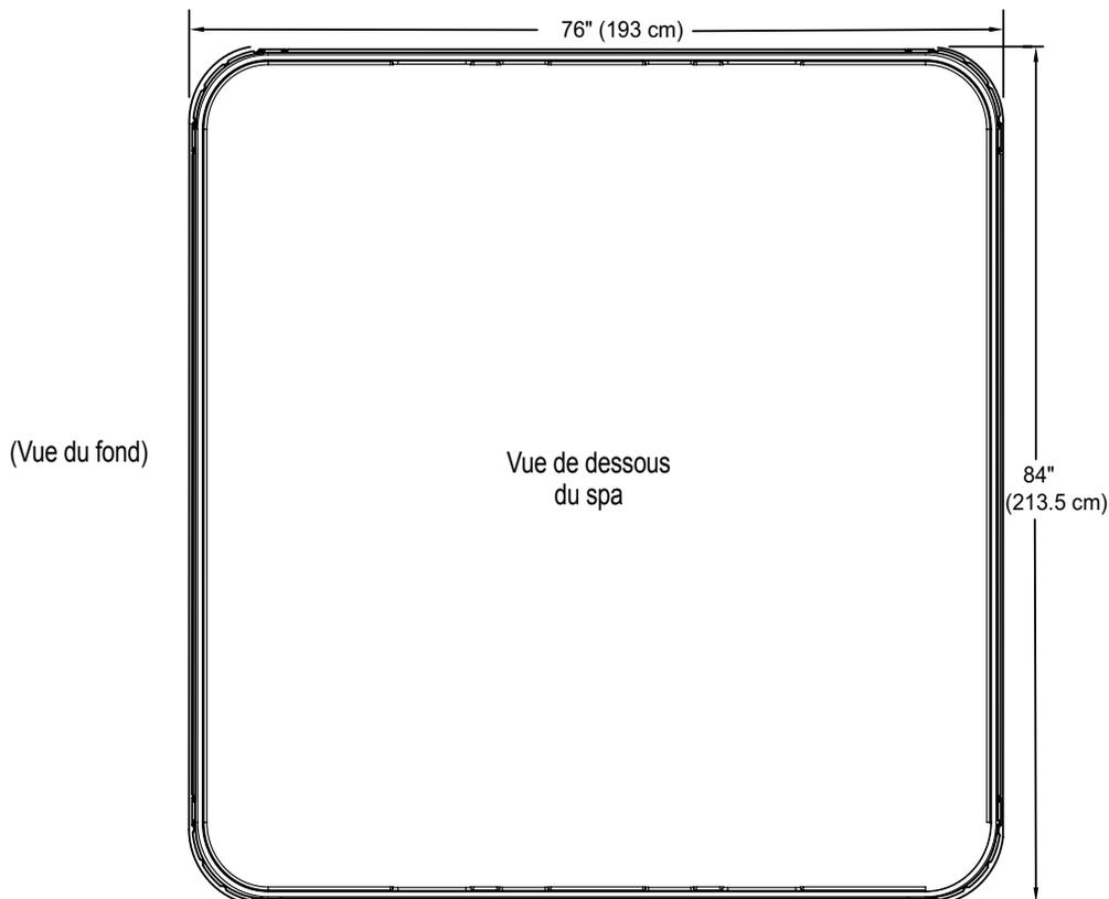
**REMARQUE :** Watkins Manufacturing Corporation exige que le spa **GLOW** soit installé sur une dalle en béton armé d'une épaisseur minimum de 10 cm ou sur une terrasse dotée d'une structure solide capable de supporter le „poids mort“ indiqué dans le tableau des spécifications du spa.
