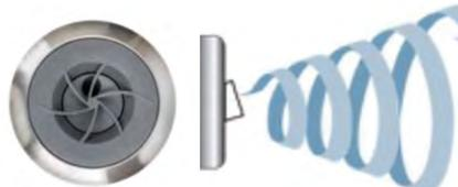
**JETS STANDARD** : ce sont des jets de taille moyenne qui produisent une action de massage apaisant au format Directionnel ou Rotatif simple.
